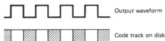
خروجی اینکودر تاکومتر و تک شیار
